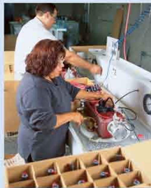
Per raggiungere i più alti standard nel controllo qualità, Hunter testa regolarmente il 100% di tutti i modelli di valvole ai livelli di pressione e di portata massimi e minimi.
